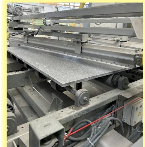
**Soffianti centrifughe e generatori di lama d'aria per asciugare, raffreddare, pulire pezzi in produzione**
